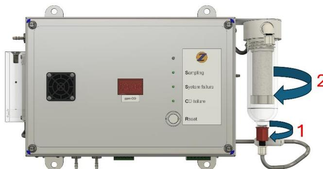
Рис. 21а: фильтр сбора газовых проб
