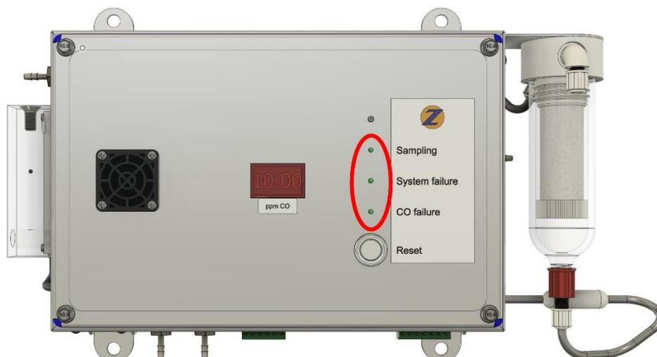
Рис. 18: статус светодиодов на передней панели
