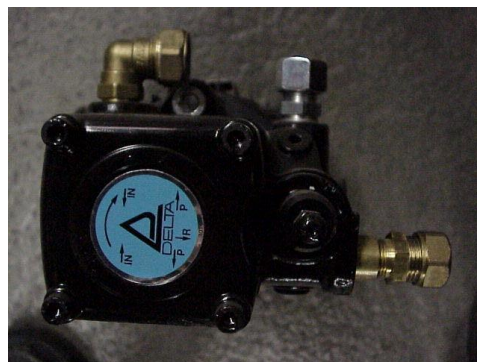
Pompset t.b.v. RKB 0,55kW Delta IN = Aanvoer R = Retour P = Pers
