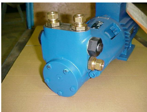
Pompset t.b.v. RKB 0,55-5,5kW S = Aanvoer R = Retour P = Pers
